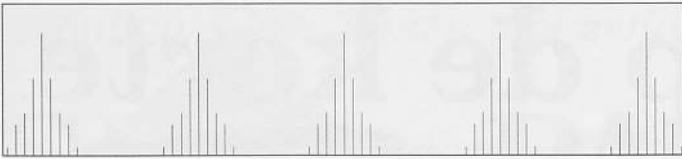
Figuur 6: Detail van een zwart-wit TV-sigitaal in het spectrum.
